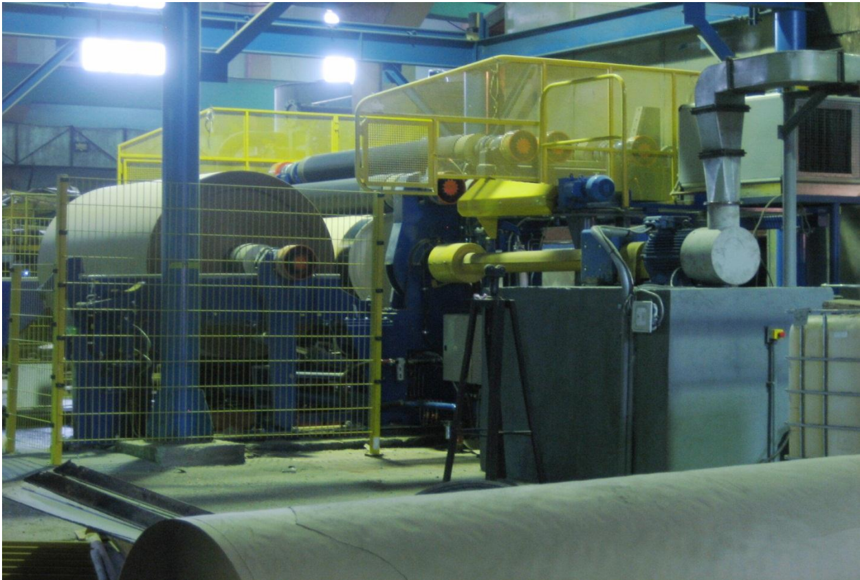
رول پیچ {ریل درام ماشینی که کاغذ تولید شده را روی لوله آهنی {اسپول} میپیچاند
